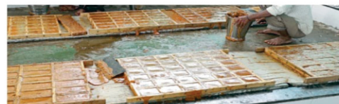
लाकडी साच्याचा वापर करून अर्ध व एक किलोच्या गुळवड्यांची निर्मिती
